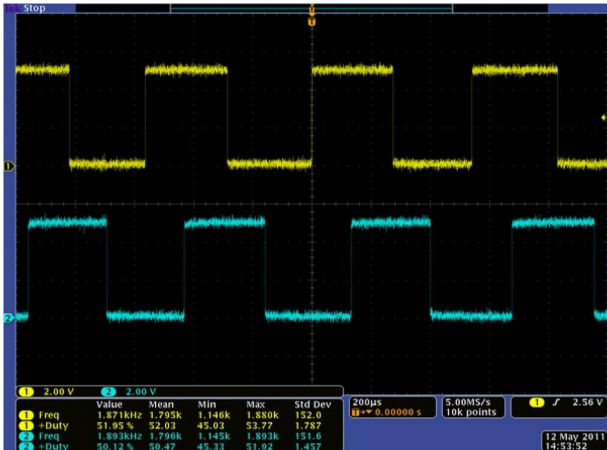
Ces deux signaux permettent de mesurer à la fois la vitesse et le sens de rotation. La mesure de la vitesse se fait simplement en comptant le nombre d'impulsions pendant un temps fixe. Les données du problème sont les suivantes :
