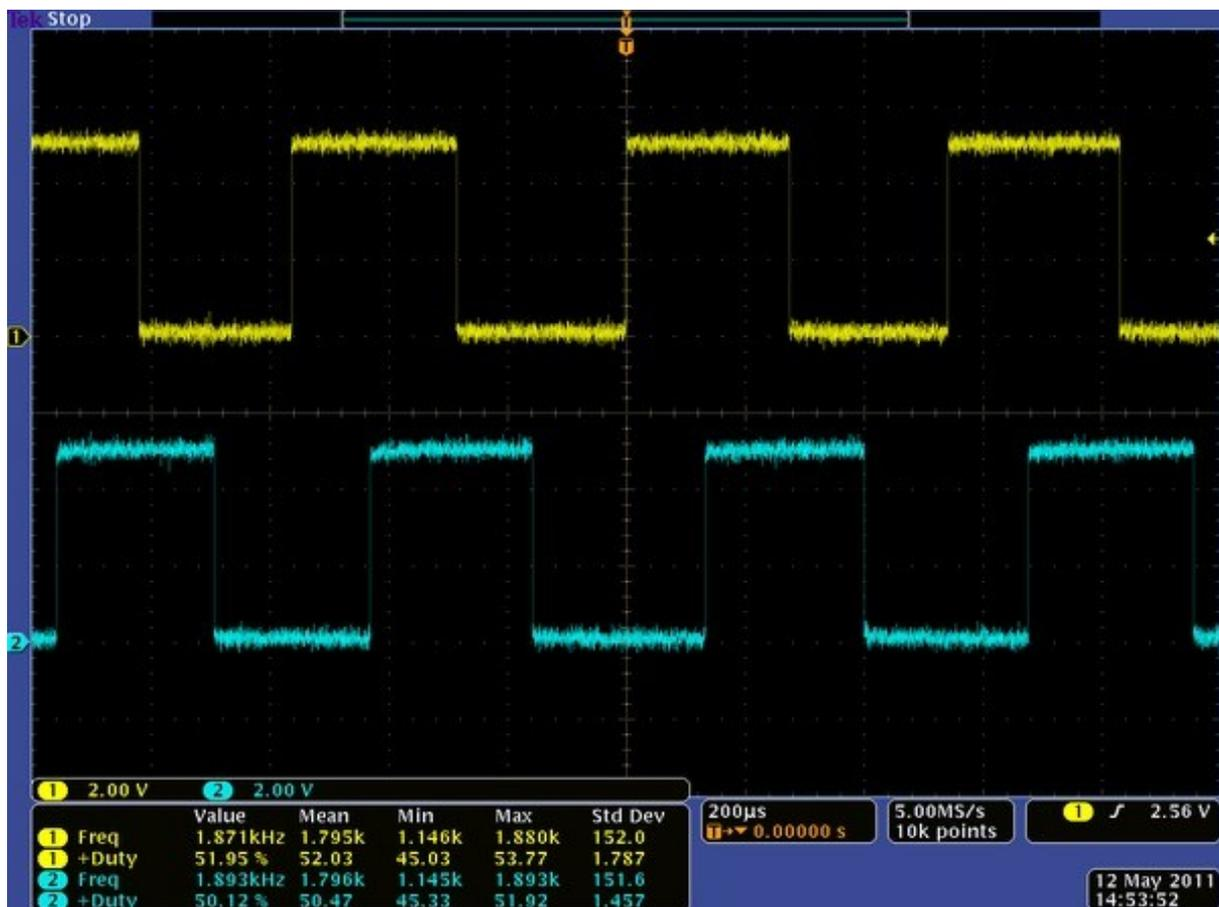
Ces deux signaux permettent de mesurer à la fois la vitesse et le sens de rotation. La mesure de la vitesse se fait simplement en comptant le nombre d'impulsions pendant un temps fixe.
